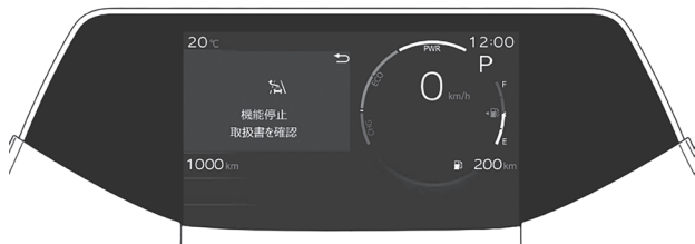
マルチインフォメーションディスプレイ 機能停止表示
