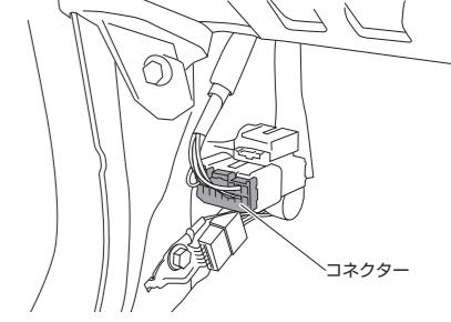
**11.** ドアハーネスを固定しているクリップ2か所のかん合を外し、助手席側のゴムブーツの両端を車体から引き出す
