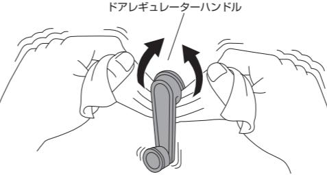
●取り外したΩ型ピンは無くさないようドアレギュレーターハンドルに取り付けておいてください。
