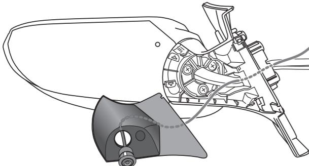
**7-8** サイドカメラのケーブルの長さを調整しながらベースカバーをドアミラーに取り付ける
