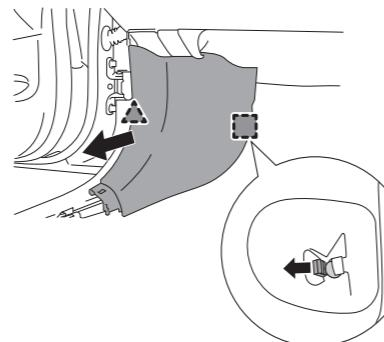
**10.** 助手席足元のカバー内側にある図で示したコネクターを引き抜く
