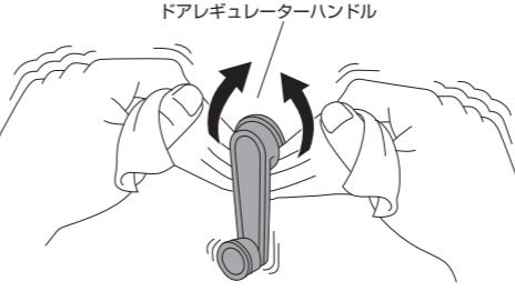
●取り外したΩ型ピンは無くさないようドアレギュレーターハンドルに取り付けておいてください。
