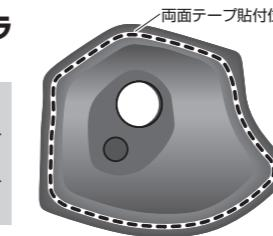
6. サイドカメラのケーブルをカメラカバーの穴に通す
