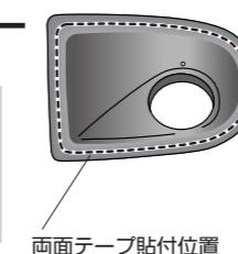
6. サイドカメラのケーブルをカメラカバーの穴に通す
