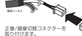
正像/鏡像切替コネクターを取り付けます。
