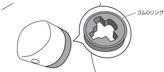
2-2 リアウォッシュャーノズル根元の上下にあるツメを精密ドライバーなどで押しながらかん合を外し、リアウォッシュャーノズルを手前に引き出す
