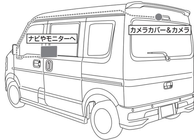
※取付概要図のカメラケーブル引き込み方法は一例です。装着する車両の内装の構造や装備品に合わせて適切な取り付けをおこなってください。
