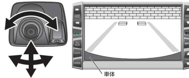
**7-3** カメラ本体をカメラカバーに差し込みます。カメラの向きを微調整します。
