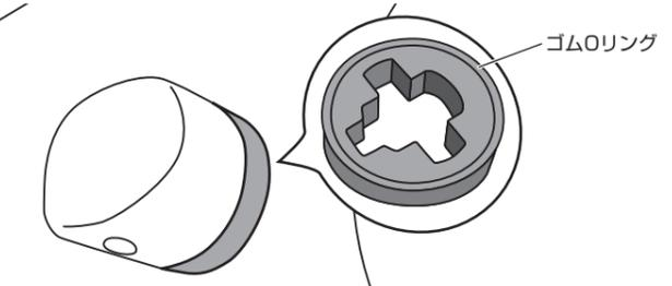
2-2 リアウォッシャーノズル根元の上下にあるツメを精密ドライバーなどで押しながらかん合を外し、リアウォッシャーノズルを手前に引き出す
