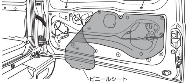
1-4 付属のアルミワイヤーの先端を曲げてビニールテープを巻きつけ、図で示した位置からアルミワイヤーを差し込み、ハイマウントストップランプ取り付け位置付近まで通す
