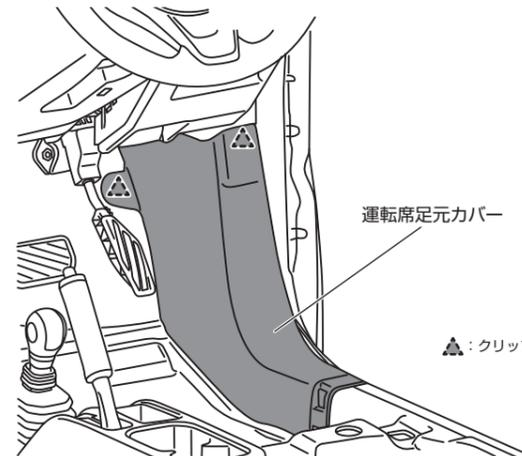
6-2 ドライバロアアウトサイドカバーを手前に引いて取り外す。キーレスプッシュスタート仕様車はエンジンスイッチ及びミラースイッチのコネクタを切り離す
