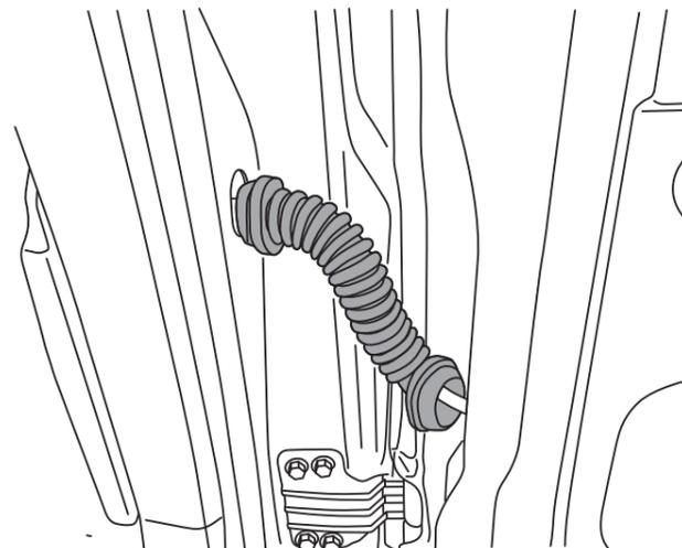
5-5 「取付概要図」を参考に、カメラケーブルを車両側ハーネスに沿って這わせ、数か所を結束バンドで固定しながら車両前方に引く
