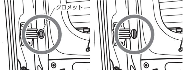
●アルミワイヤーの先端はなるべく丸くなるように曲げてからビニールテープを巻いてください。また、先端が少し右を向くように軽く曲げてから差し込むと通しやすくなります。
