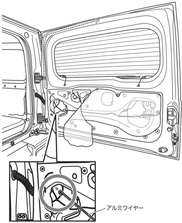
●図で示したグロメットを取り外し、この穴からアルミワイヤーが見えるように通してください。
