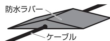
ボディの穴にケーブルを通す場合は、必要に応じて防水グローメットを使用してください。防水グローメットは一部をカットして使用します。
