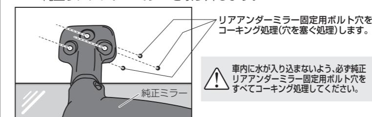
リアアンダーミラー固定用ボルト穴をコーキング処理(穴を塞ぐ処理)します。
