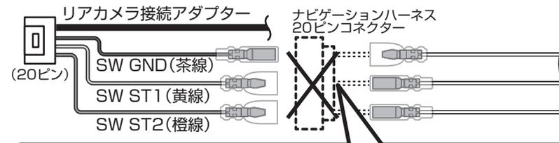
配線切断後に同梱のギボシスリーブとギボシを取り付け、本製品と接続する
