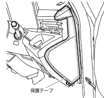
5-2 リムーバツールを使用して右インストルメントサイドフィニッシャのクリップのかん合を外し、右インストルメントサイドフィニッシャを取り外す
