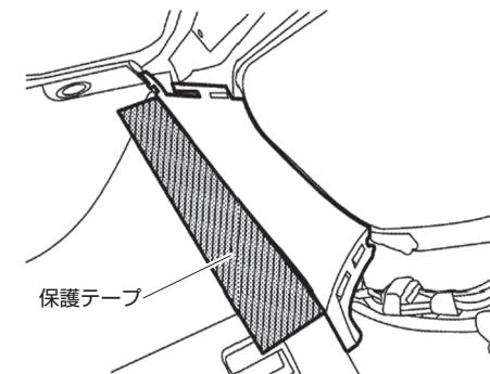
4-2 リムーバツールを使用してインストルメントサイドパネル取付クリップのかん合を外し、インストルメントサイドパネルを取り外す。
